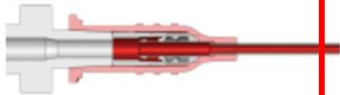
防针刺伤动静脉留置针 (主动安全方式)
