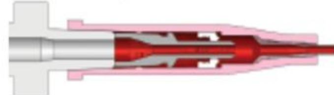
竞争品牌的血流控制导管 (主动安全方式)
